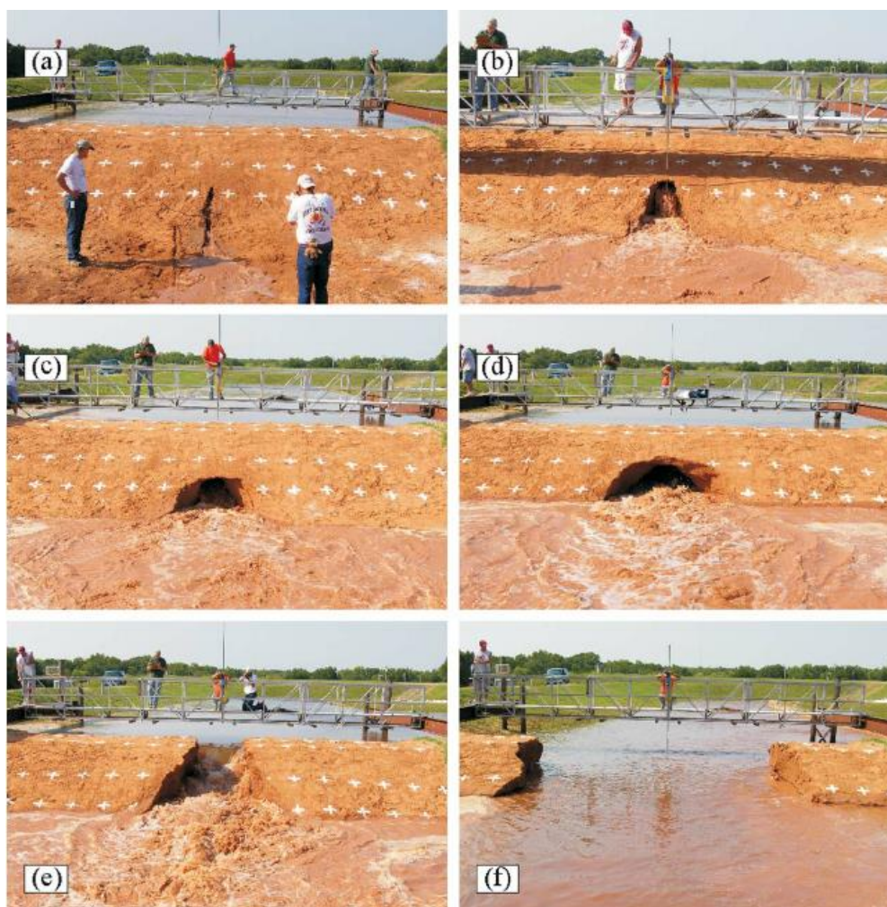
Slika 30: Simulacija pojava in razvoj različnih faz notranje erozije (Altinakar et al., 2011).
