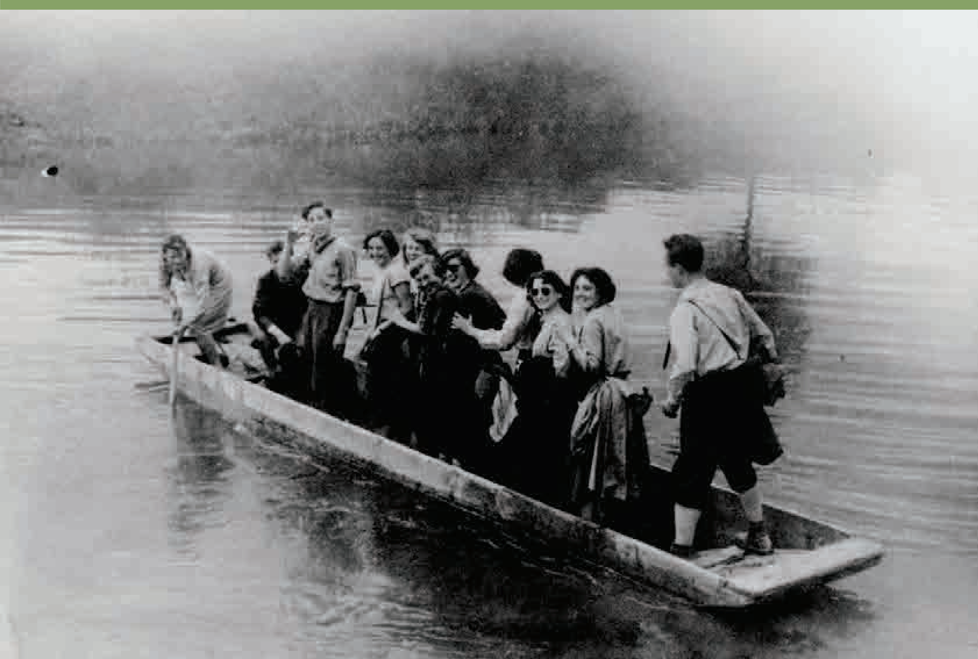
Čolni, narejeni iz enega debla in razširjeni z desko, so poznani tudi kot drevaki ali deblaki. Poleg večjih ladij so bili pomembno prevozno sredstvo za prevažanje ljudi in materiala po Ljubljani in pritokih. Fotografije prikazujejo prečenje Ljubljane pri Kamini v Bevkah, ki je bil prehodna točka od prazgodovine dalje. Vir: Arhiv družine Luglio
